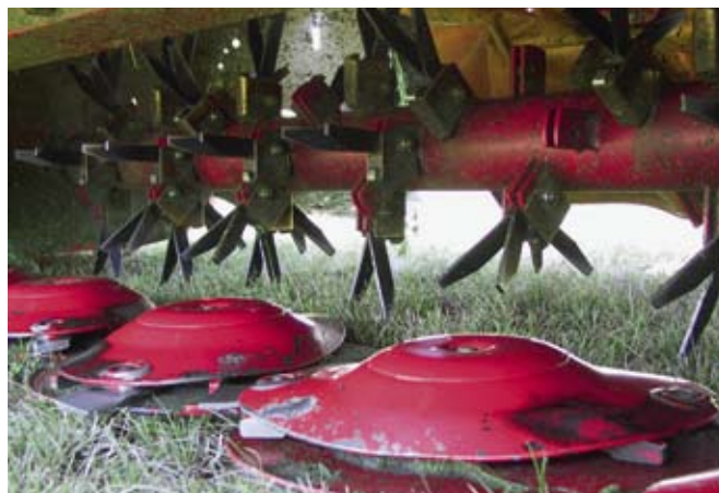
Aufbereiter mit integrierten Zinken.
