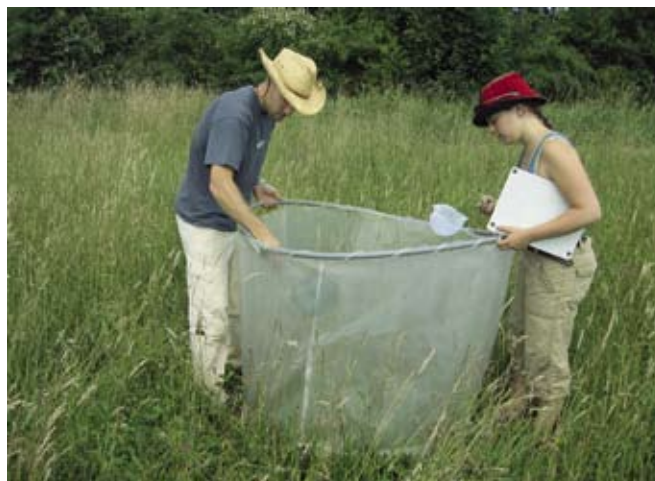
Abb. 8: Mit dem Biozooenometer wurden die Heuschreckendichten ermittelt.
